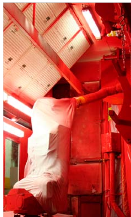
Окрасочный робот, работающий над заготовкой
