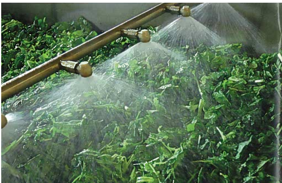
На заводе в Сякюля перед переработкой шпинат поливают и промывают. На фото показан процесс промывания шпината.
